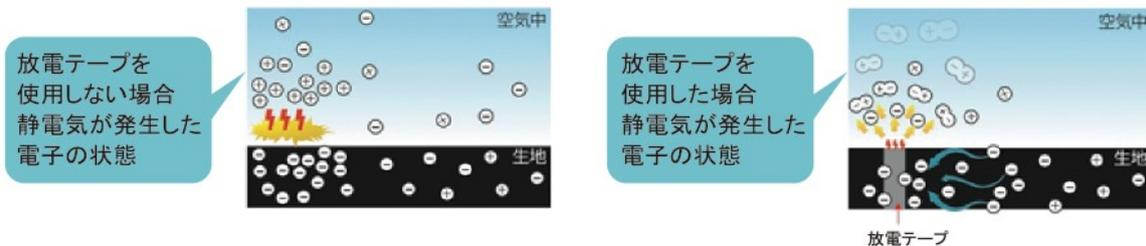
放電テープに ⊖ が集まり、空気中の ⊕ と中和され瞬時に生地の帯電圧を下げます。
