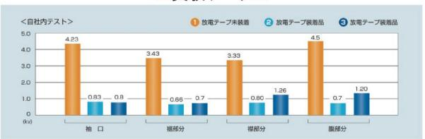
上の実験結果のとおり放電テープを装着した物は、放電テープの装着時と未装着時では20%~30%の電圧値をしめしている。
