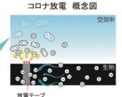
放電テープに (一) が集まり、空気中の (十) と中和され瞬時に生地の帯電圧をさげます。
