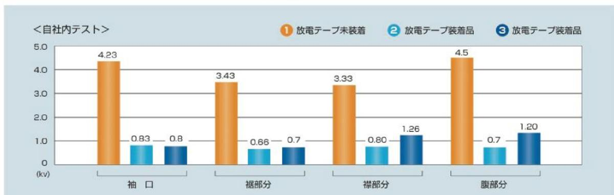
上の実験結果のとおり放電テープを装着した物は、放電テープの装着時と未装着時では20%~30%の電圧値をしめしている。
