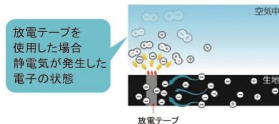
放電テープに ⊖ が集まり、空気中の ⊕ と中和され瞬時に生地帯電圧を下げます。
