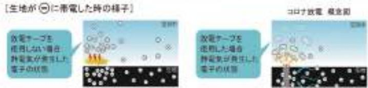
放電テープに⊖が重なり、空気中の⊕と中和され同時に生地の帯電圧を下げます。
